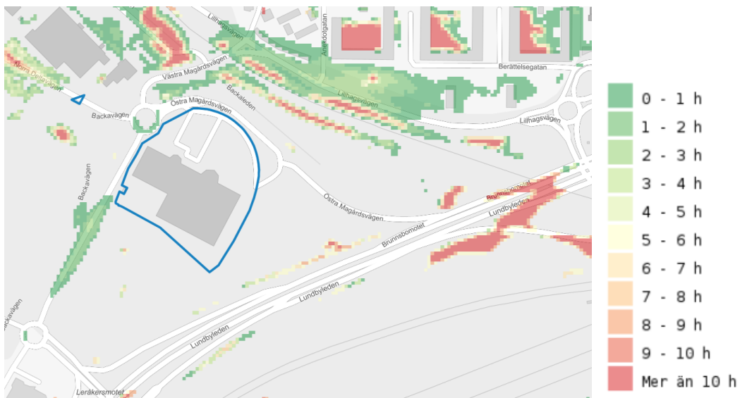
Figur 10. Befintlig skyfallssituation vid ett klimatanpassat 100 årsregn - varaktighet (h) för vattendjup över 0,2 m.
